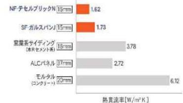
アイジーサイディングは断熱性に優れたポリイソシアヌレートフォームを採用し、他の外壁材と比較しても抜群の断熱性能を誇ります。高い断熱性で冷暖房費などの光熱費を削減でき、省エネルギーでCO<sub>2</sub>の削減に貢献します。
